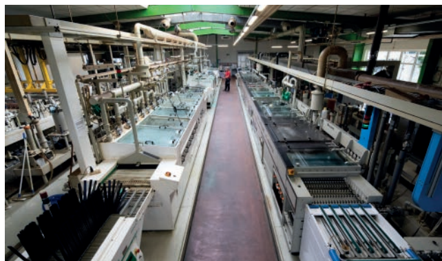
Der Weg, den eine Leiterplatte durchläuft, ist ungefähr 1,5 km lang und beinhaltet viele Bearbeitungsschritte.
